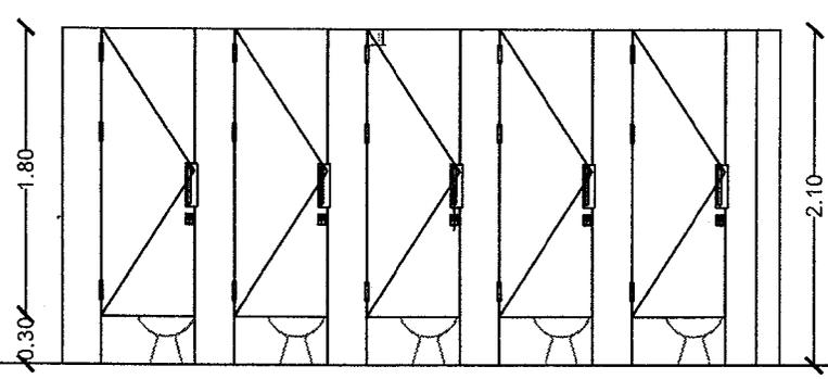
Estructura de tubos de aluminio 40 x 40 x 1.5 P2698-Aluar . Uniones mediante insertos de perfil de aluminio U, remaches y tornillos.
